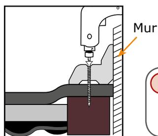
**!** Visser la vis et la rondelle jusqu'à ce qu'elles reposent de façon uniforme.
