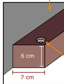
**IMPORTANT:** couper si nécessaire le profilé de cadre, placer des fixations supplémentaires dans le profilé de cadre
