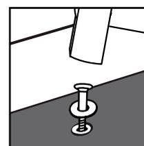
Frapper le clou et la rondelle jusqu'à ce qu'ils reposent de façon uniforme
